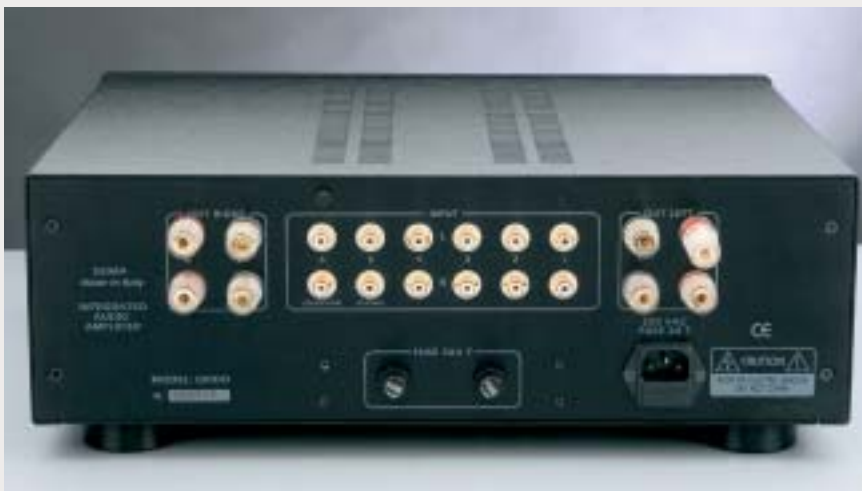
Il pannello posteriore ospita cinque ingressi ad alto livello e un'uscita per registratore. Nei portafusibili trovano alloggio gli elementi da rimuovere nel caso di un prolungato distacco dalla rete elettrica, accorgimento necessario per evitare il completo scaricarsi degli accumulatori.
