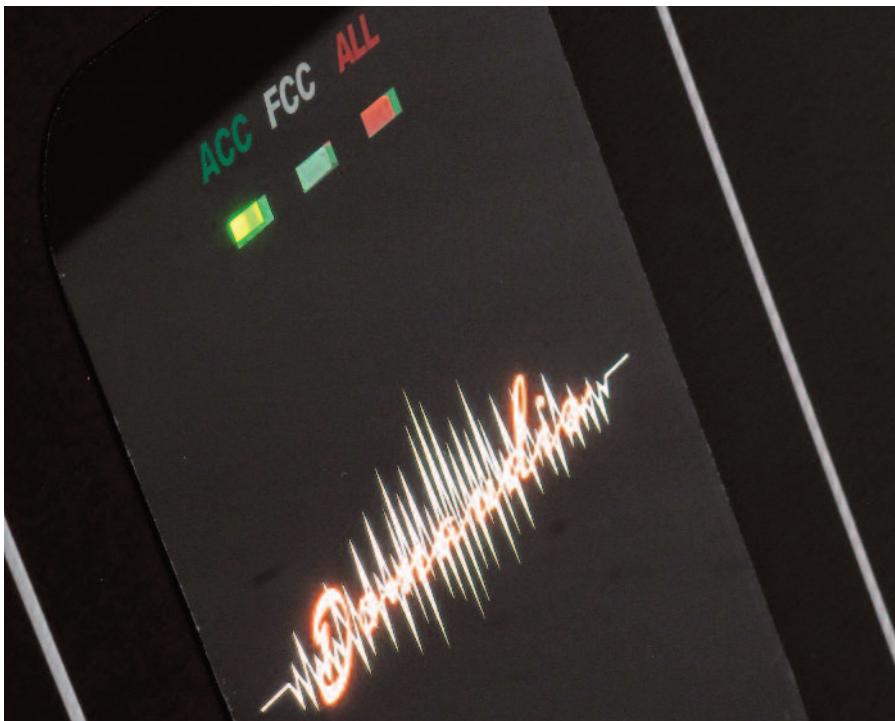
Dettaglio della parte frontale con in evidenza il logo retroilluminato e le tre spie che indicano le varie fasi di operatività del filtro.
